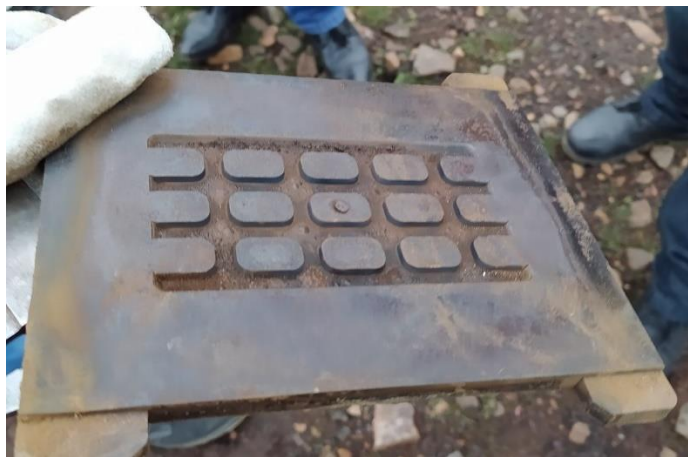
Фото 3.2 - Прокладки підрейкова Zw 900 SL-2 з жорсткістю 150 кН/мм
