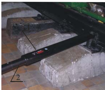
Рис. 3. Электронный динамометрический ключ во время стендовой тарировки: 1 – электронное табло; 2 – ручка (плечо)
