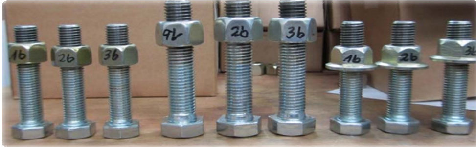
Рис. 4. Зразки FS-гайок для визначення стопорного моменту автоматично до і після впливу низької температури, а також випробувань навантаженням після впливу низької температури
