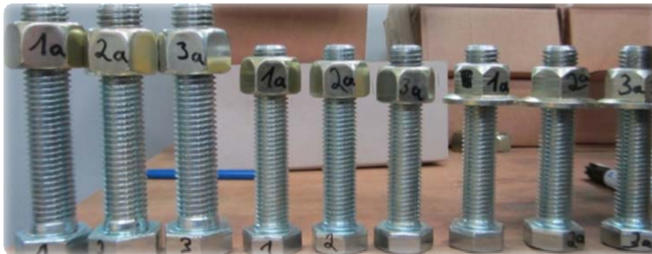
Рис. 2. Зразки FS-гайок для визначення стопорного моменту моментним ключем
