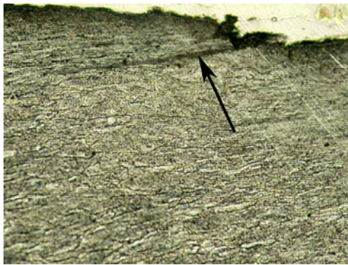
Рис. 1. Умовна схема (а) профілю кочення залізничного колеса та структура металу (б, \times 500 ) в приповерхневому шарі при експлуатаційних навантаженнях
