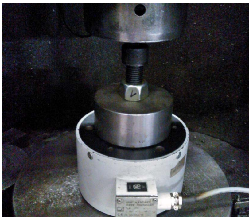
Рис. 8. Випробування FS-гайки M24 навантаженням
