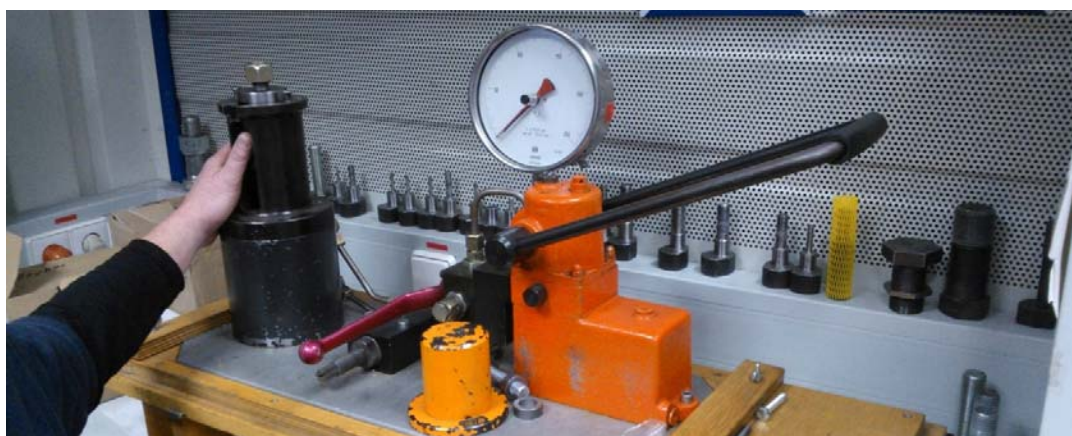
Рис. 7. Випробування FS-гайки M20 навантаженням
