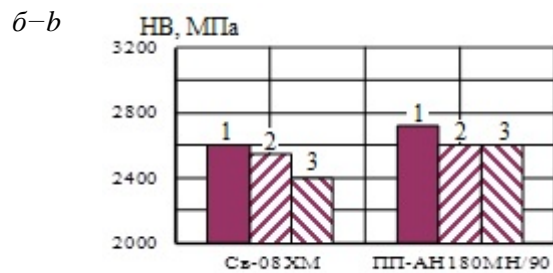
Рис. 8. Твердість металу, наплавленого при температурі 150 °С (а) та 250 °С (б): 1 – одношарове наплавлення; 2 – двошарове; 3 – наплавлення в три шари
