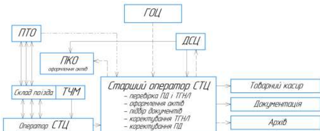
Рисунок 3.2 – Схема документообігу на поїзди з переробкою на станції Злочів
