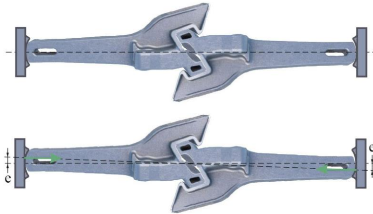
Рис. 2. Передача автозчепленням поздовжнього зусилля з ексцентриситетом
