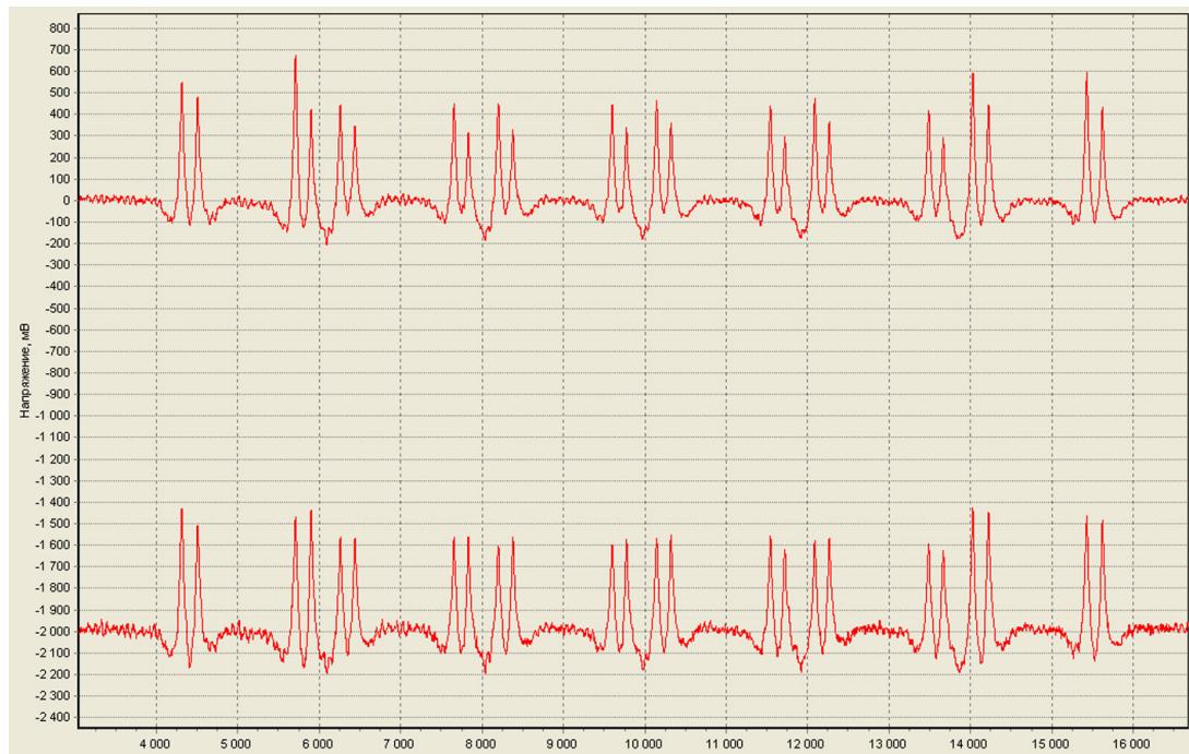
Рисунок 4.14 – Приклад запису напружень в рейці (напруження на кромці підшви від проходження поїзда Skoda із швидкістю 176 км/год)
