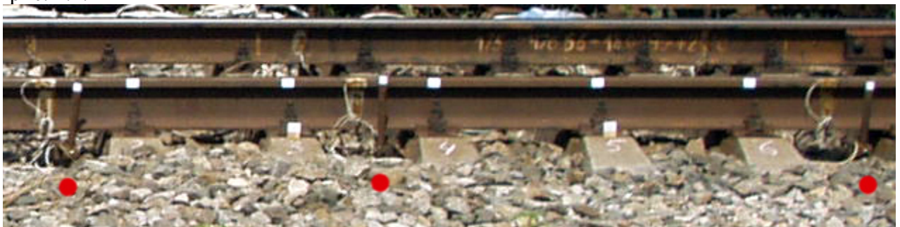
Рисунок 4.2 – Послідовність трьох перерізів рейки, обладнаних датчиками
