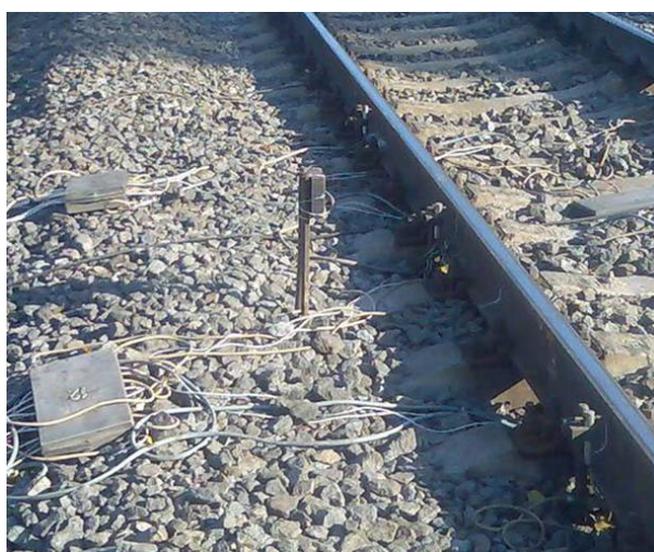
Рисунок 4.9 – Послідовність трьох перерізів рейки, обладнаних датчиками
