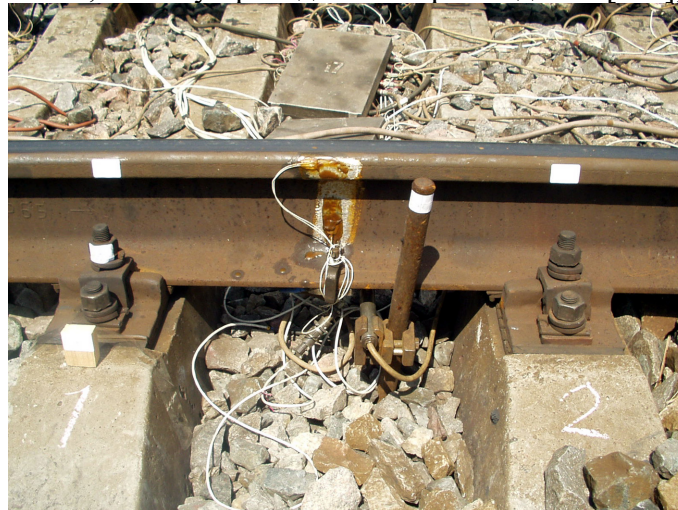
Рисунок 4.13 – Встановлення датчиків на рейці
