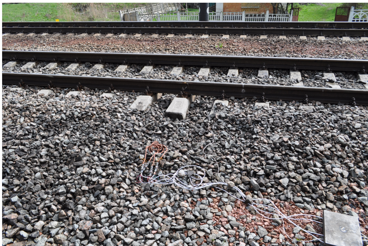
Рис. Д.6 – Дослідна ділянка, обладнана месдозами
