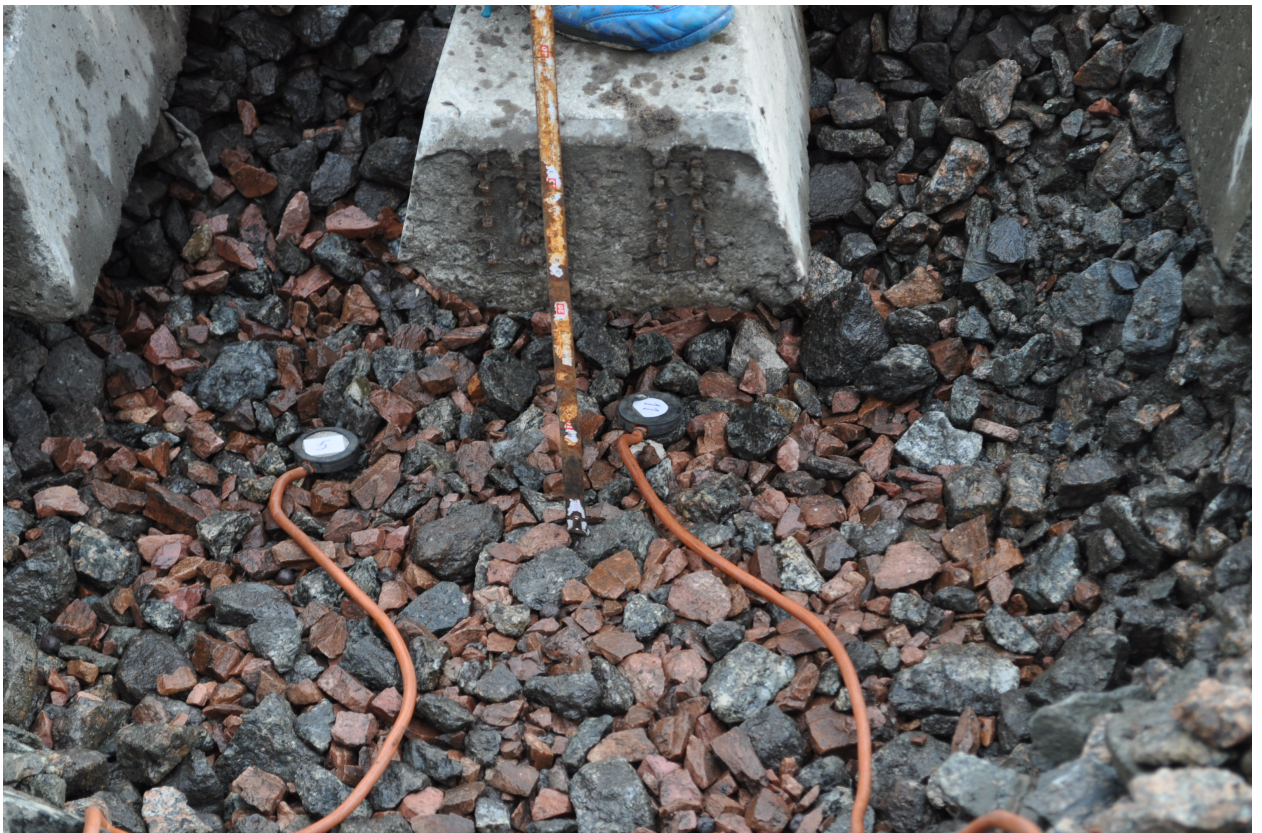
Рис. Д.4 – Глибина встановлення 2-го рівня месдоз 20 см від підшви шпали
