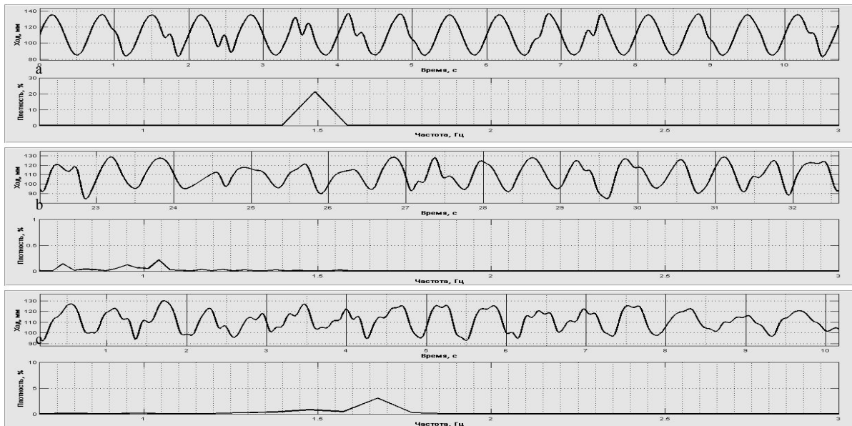
Рис. 3. Результати аналізу коливань: а) зрізкової функції; б) еталонного відеозапису коливань візка мод. 18-100 на 9...20 с; с) еталонного відеозапису коливань візка мод. 18-100 на 0...10 с
