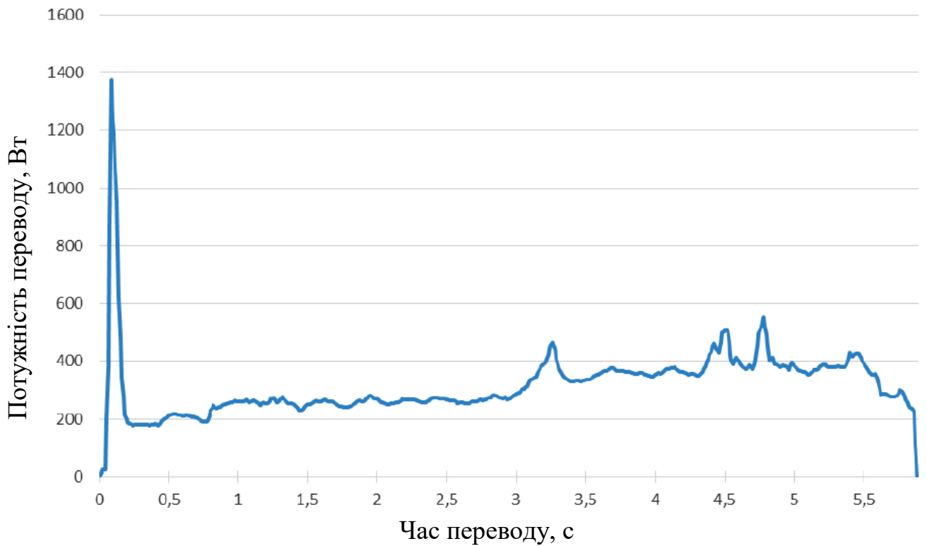
Рисунок 4.8 – Прояв забруднень стрілочних башмаків на графіку потужності перевodu
