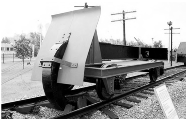
Рис. 5. Путеразрушитель конструкции, предложенной подпрапорщиком Червяком
