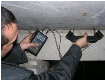
Рис. 3.6. Прозвучування конструкції приладом УК-39
