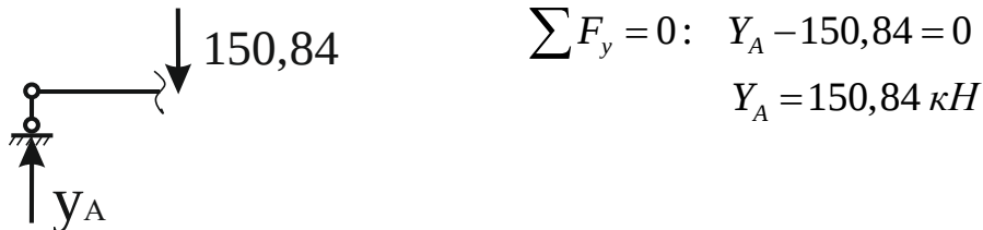
Рис. 2.73 Схема внутрішніх зусиль та опорних реакцій в опорі А
