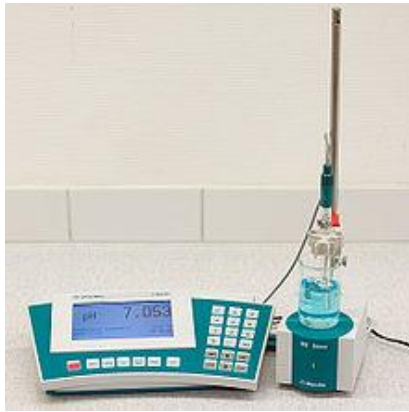
Рисунок 12 – Вигляд товарних моделей рН-метрів [2]: а – напівстаціонарний; б – скомбінований з мілівольтметром
