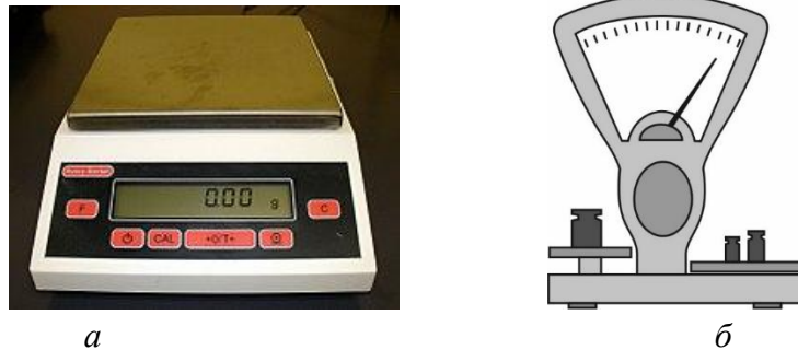
Рисунок 1 – Вигляд ваг: а – пружинні тензометричні ваги з електронною індикацією; б - ваги важільні з механічною (стрілочною) індикацією [2]
