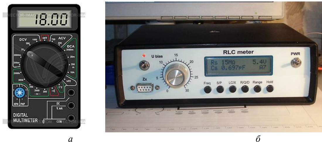
Рисунок 10 – Приклади товарних моделей мультиметрів з цифровою індикацією [2]: а – АВО-метр; б – RLC -метр
