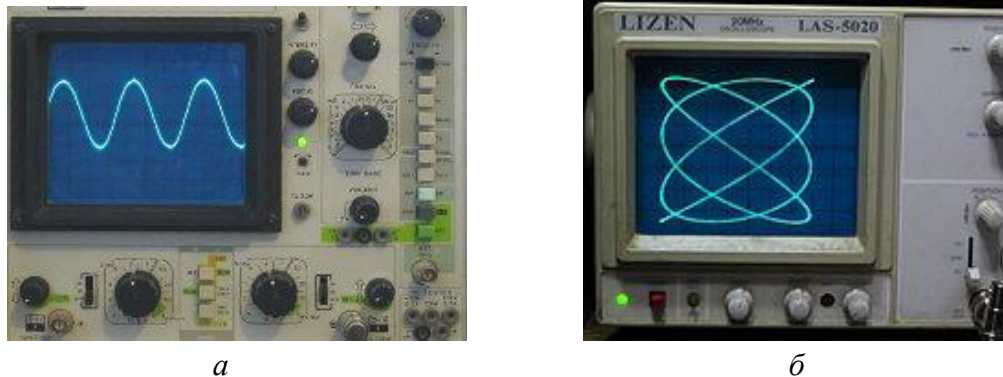
Рисунок 5 – Вигляд візуалізованого електричного сигналу змінної частоти на екрані електронного осцилографа [2]: а – розгортка сигналу; б – фігури Ліссажу при аналізі двох ортогональних сигналів
