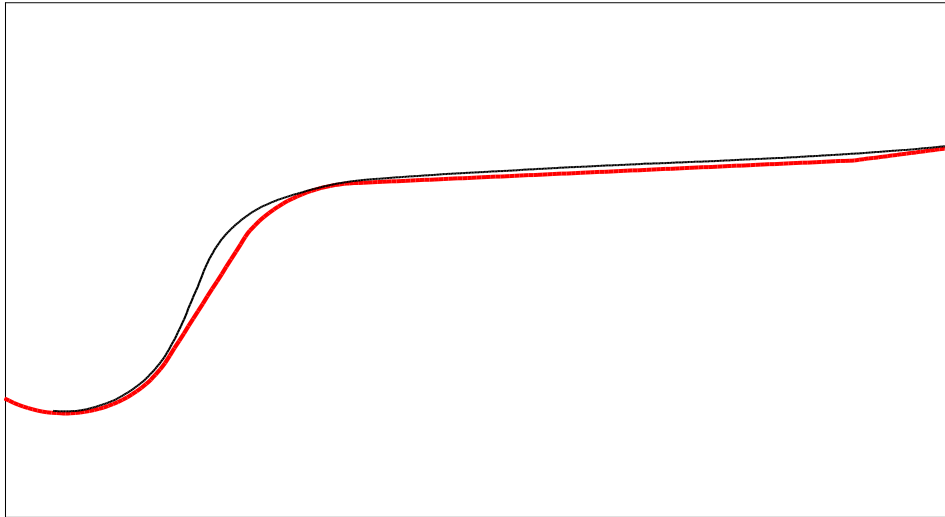
Рис. 2.12. Рабочая часть малоизношенного обода колеса с первоначальным стандартным профилем:
