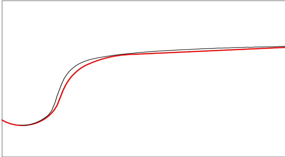
Рис. 2.18. Рабочая часть малоизношенного обода колеса с первоначальным профилем ИТМ-73:
