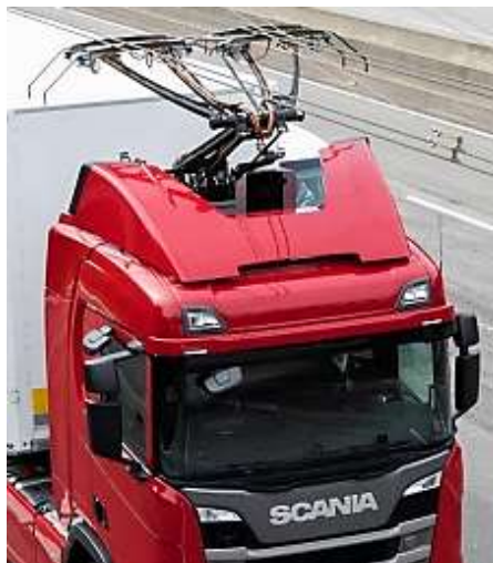
Рисунок 5 – Струмоприймач вантажного автомобіля (сідлового тягача) з контактної мережею
