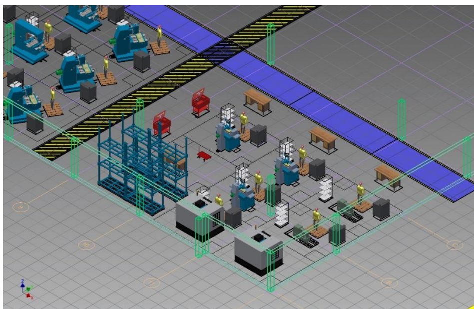
Рисунок 5 – Формування робочого простору з відображенням подробиць у середовищі Factory Design Suite – вигляд у просторі
