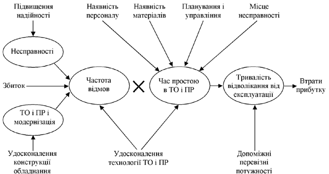
Рисунок 3.1 – Схема системи ТО та ПР локомотивів четвертого покоління
