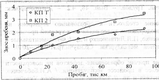
Рис.7. Залежність зносу гребеня коліс від пробігу за даними маршрутних випробувань ГНДЛ «Вагони» ДПТ.
