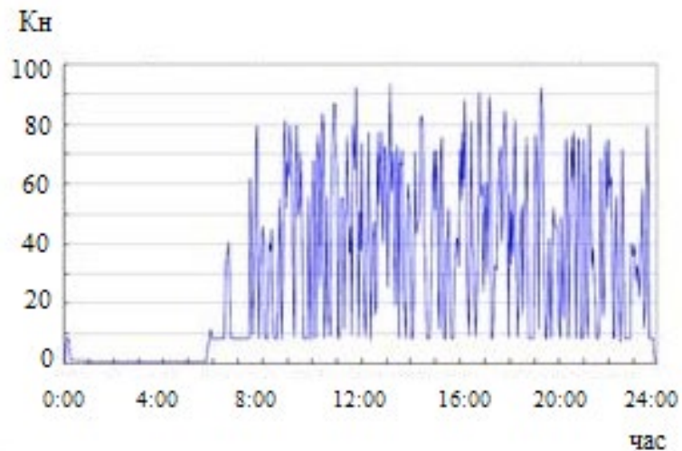
Рис. 3.8. Залежність коефіцієнту небалансу за струмом в лінії А від часу (протягом доби)
