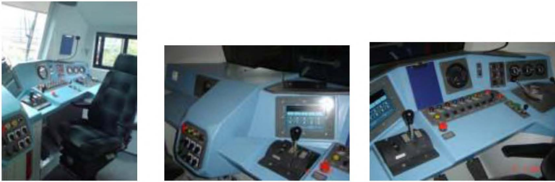
Рисунок 2.40 – Модернізований пульт управління у локомотиві типу 311Д
