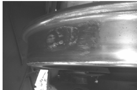
Рис. 1. Ползуны на поверхности катания колес
