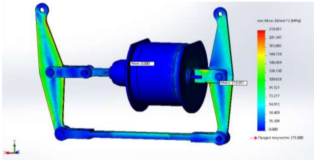
Рисунок 5.14 – Епюра напружень для F_{ш} = 3846,5 кг
