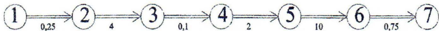
Рис. 1. Сітвовий графік виконання робіт з влаштування вертикальних несучих елементів зі з'єднанням арматури ванношовним зварюванням. / A network progress chart is from arranging of vertical bearing elements with connection of armature to the welding of bars.
