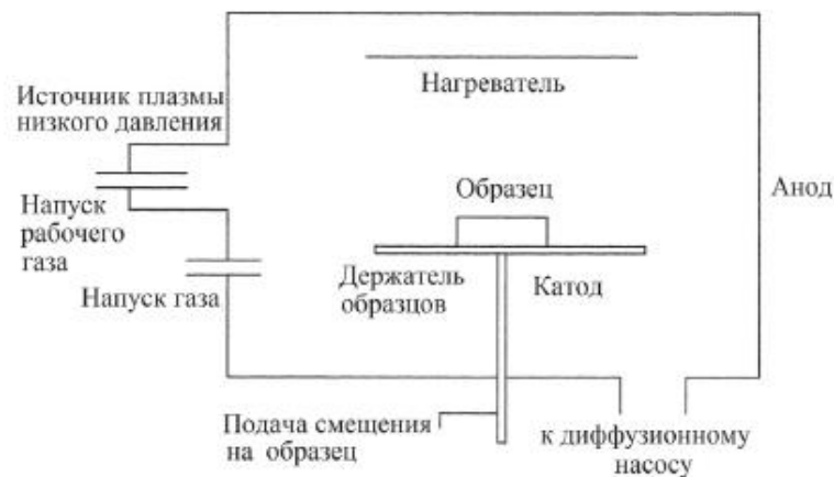
Рис. 4 Схема реактора для плазменого азотування з використанням дугового джерела плазми низького тиску [11]
