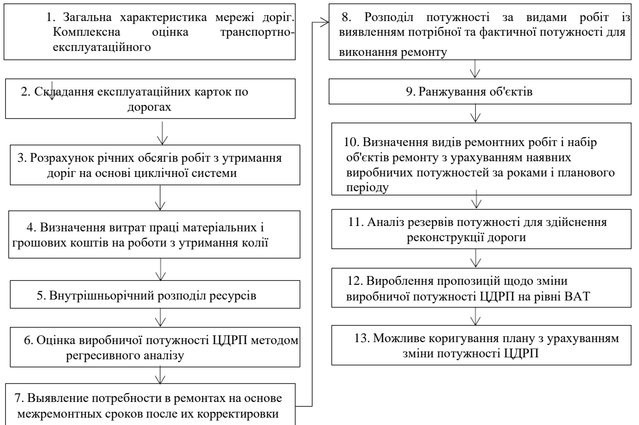
Рисунок 3.1 – Етапність формування плану утримання та ремонту залізниць (ресурсно-технологічна модель еталонної ділянки)
