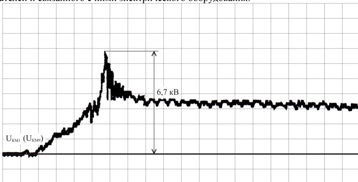
Рис. 3. Осциллограмма напряжений при отключении линейного контактора КМ1 (КМ9)
