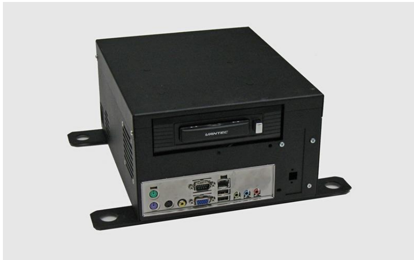
Рисунок 1.4 – Відеосервер системи «Поїзд-Відео»
