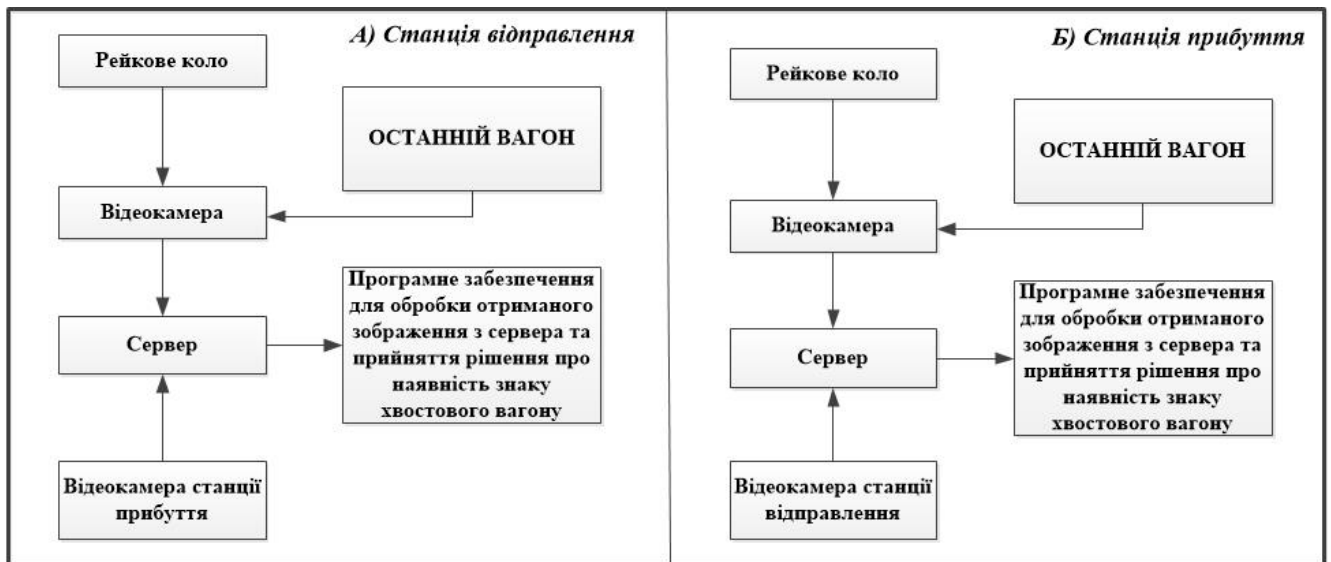
Рисунок 2.8 – Система КВП з двома пристроями відеоспостереження:
