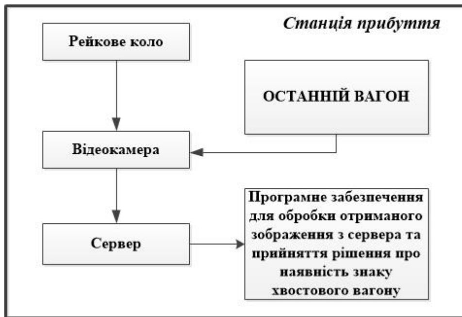
Рисунок 2.9 – Система КВП з одним пристроєм відеоспостереження
