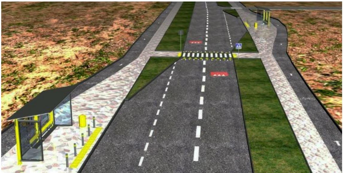
Рисунок 2.24 – Візуалізація зупинок громадського транспорту із заїзними кишенями
