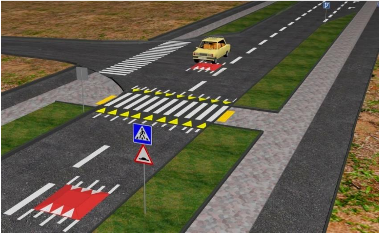
Рисунок 2.27 – Візуалізація запроєктованого підвищеного пішохідного переходу та гумових дорожніх пагорбів
