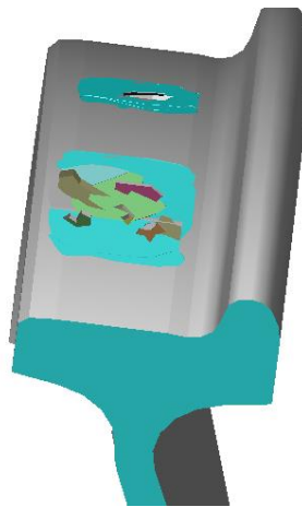
Рисунок 22 – Пошкодження 22-1 вищербини по світлих плямах, повзунам, «наварам» (ділянки поверхні кочення, які викришилися більше допустимих розмірів чи з наявністю в них тріщин чи розшарувань, що йдуть в глибину металу)
