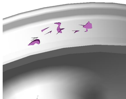
Рисунок 23 – Пошкодження 22-2 вищербини по тріщинах від втоми (ділянки поверхні кочення, які викришилися більше допустимих розмірів чи з наявністю в них тріщин чи розшарувань, що йдуть в глибину металу)
