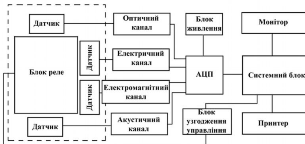
Рис. 3. Структурна схема ВДК на основі АЦП
