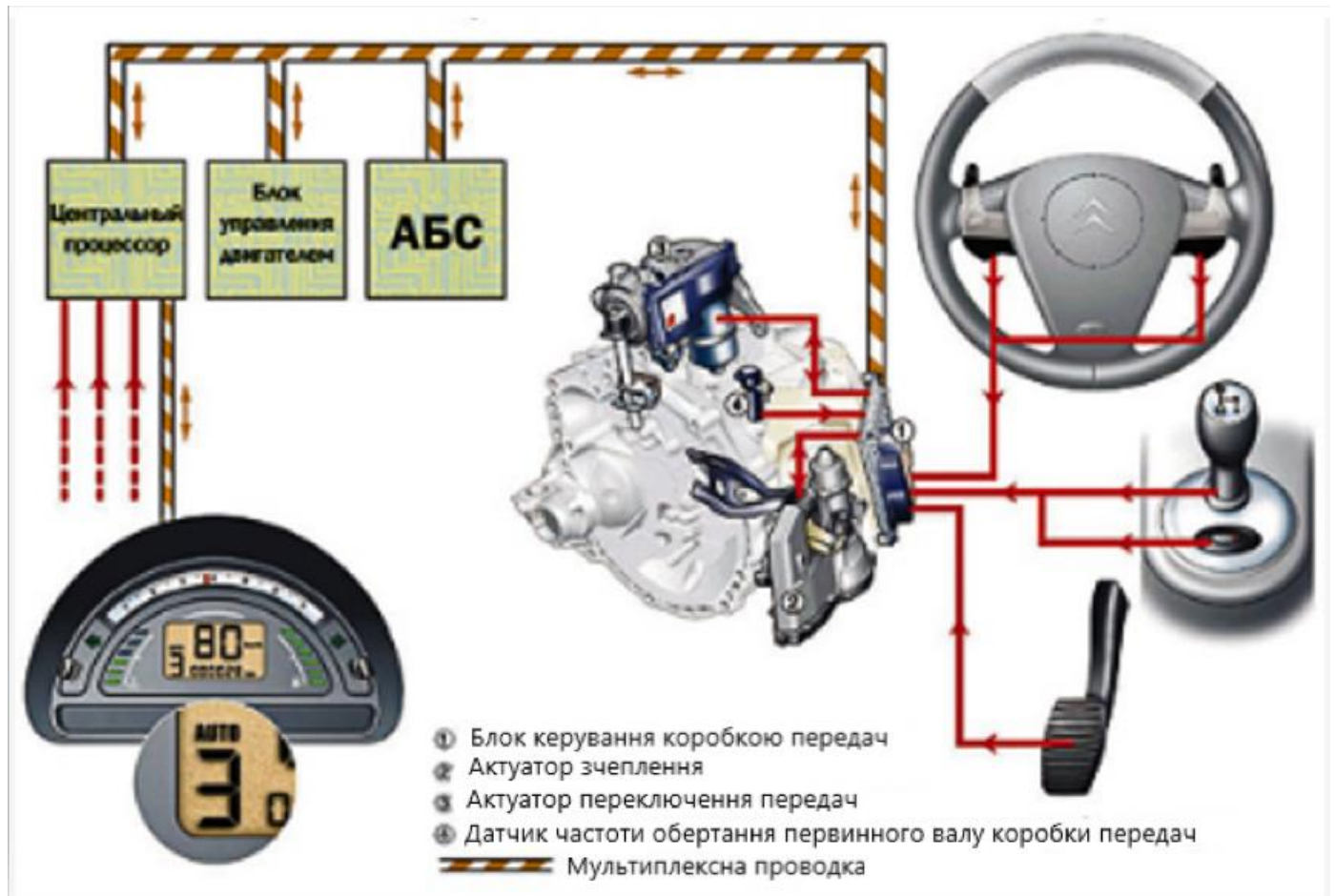
Рис. 1.3. Схема роботи РКПП [3]
