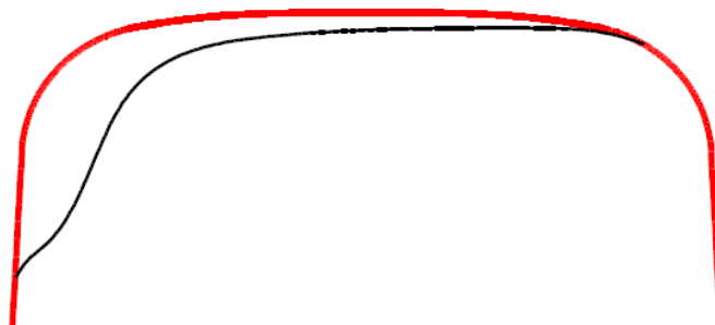
Рисунок 2.6 – Форма середньозношеної головки рейки Р65 у кривій радіусом 600 м
