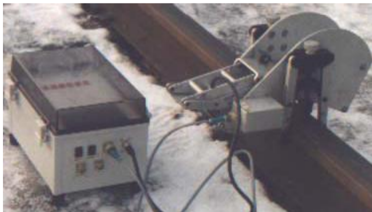
Рисунок 2.1 – Профілограф рейковий переносний ПРП-1
