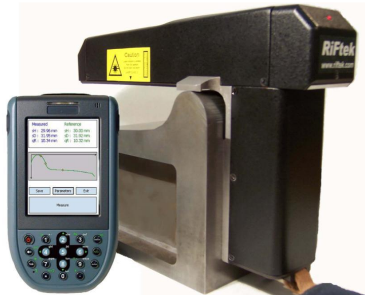
Рисунок 2.8 – Лазерний профілометр колісних пар
