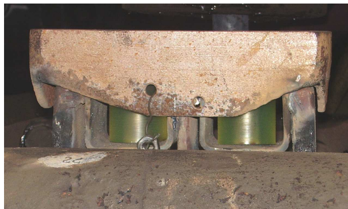
Рис. 5.2. Зони відмов при експлуатаційних випробуваннях ковзунів ТАУС 0 : B1 — ковпака; B2 — середнього ребра
