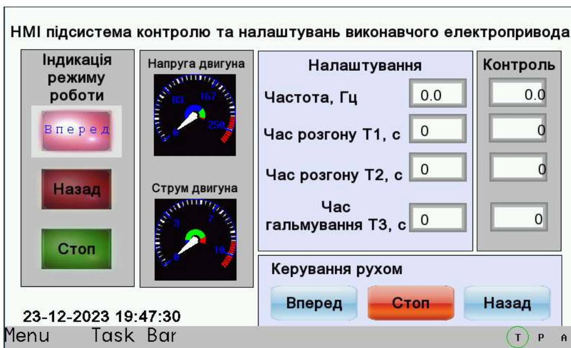
Рисунок 4.13 – Демонстрація активного стану сигнальної лампи «Вперед»
