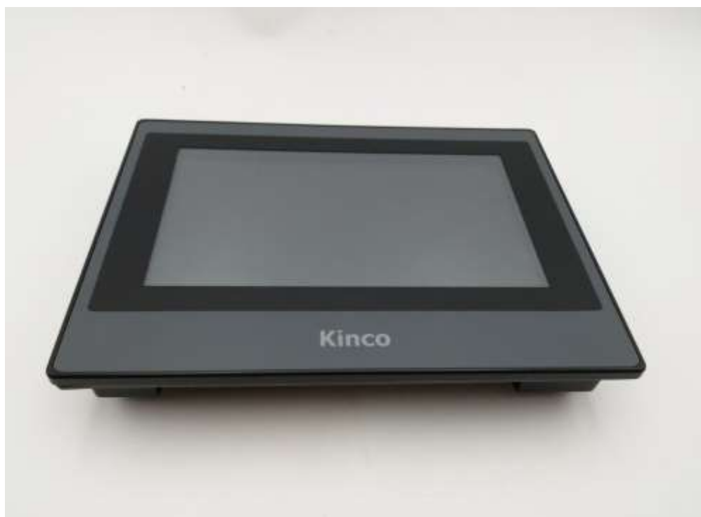
Рисунок 1.10 – HMI панель оператора Kinco MT4434TE
