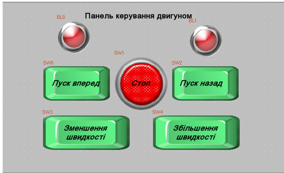
Рисунок 1.7 – Кадр графічного інтерфейсу панелі оператора в області редагування конфігурації середовища Kinco HMIware
