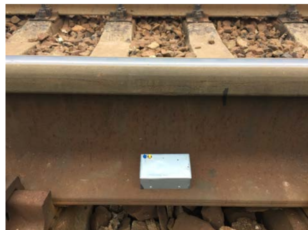
Рис.1. Акселерометр на підшві рейки Р65
