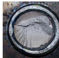
Рис. 11. Зломи зварних модельних зразків № 3 (а) та № 4 (б)
