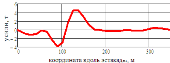
Рис. 10. Линия влияния усилия, передающегося посредством тяг на устой № 0 от действия вертикальной силы 100 т
