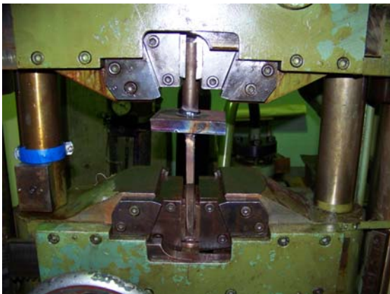
Рис. 5. Зразок зварного з'єднання у випробувальній машині ЦДМ-10пу під час випробування на втому
