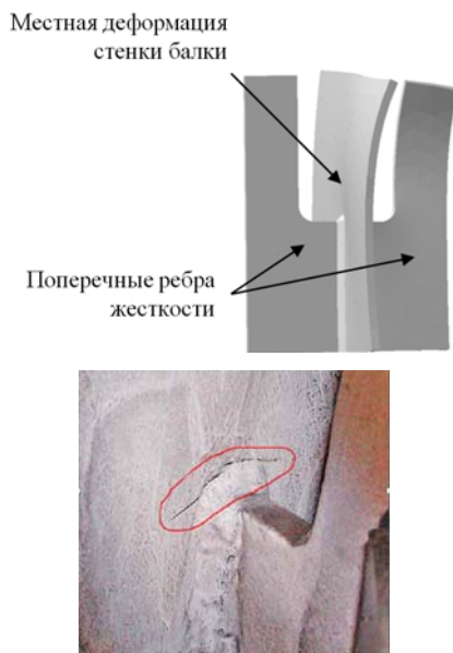
Рис. 1. Местная деформация стенки балки и наличие трещины усталости в зоне сварного соединения
