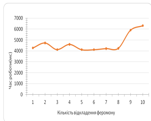
Рис. 18. Час роботи програмної моделі за кількістю відкладеного феромону
