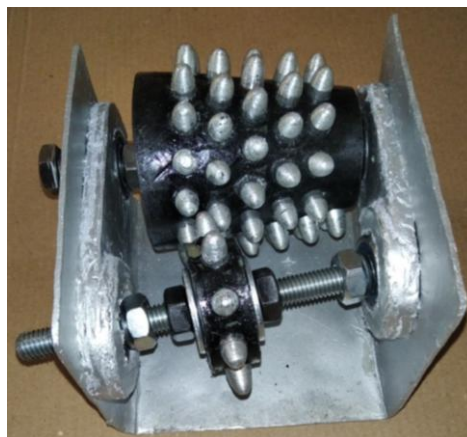
Рис. 3. Прототип зубчатого варіатора (діюча модель)
