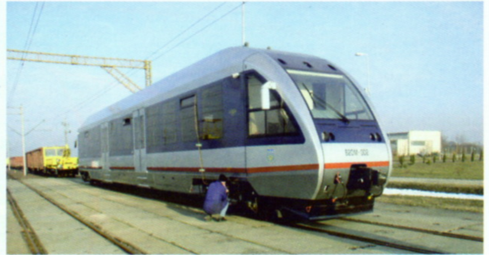
Рис. 7. Приймальні випробування рейкового автобуса («PESA Bydgoszcz SA», Польща)
