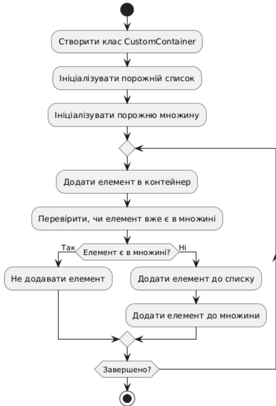
Рисунок 2.2 – Блок-схема створення класу CustomContainer
