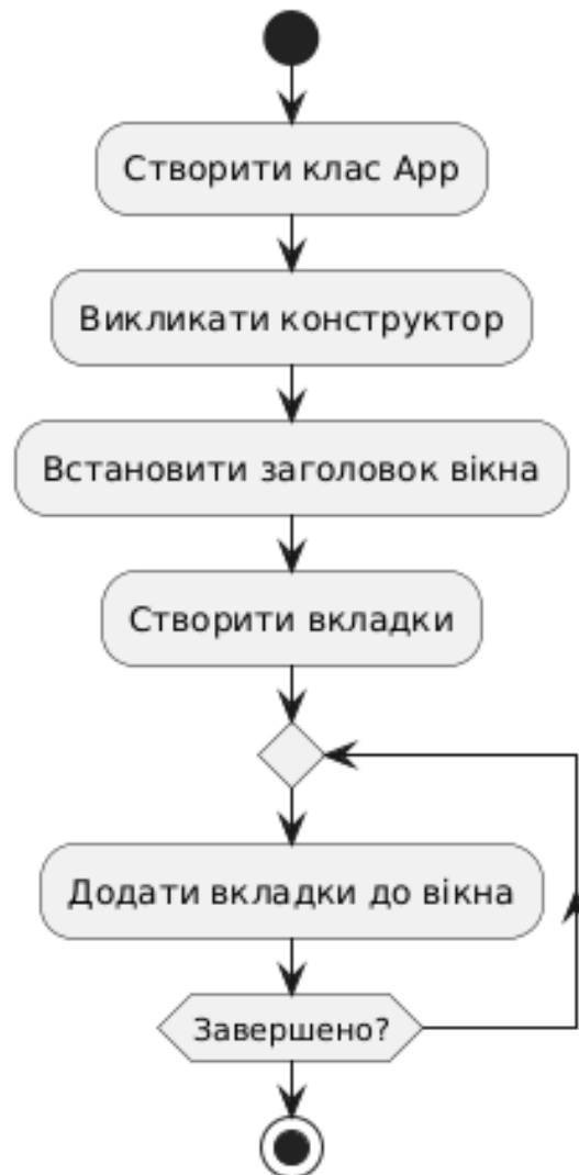
Рисунок 2.9 – Блок-схема ініціалізації класу App
