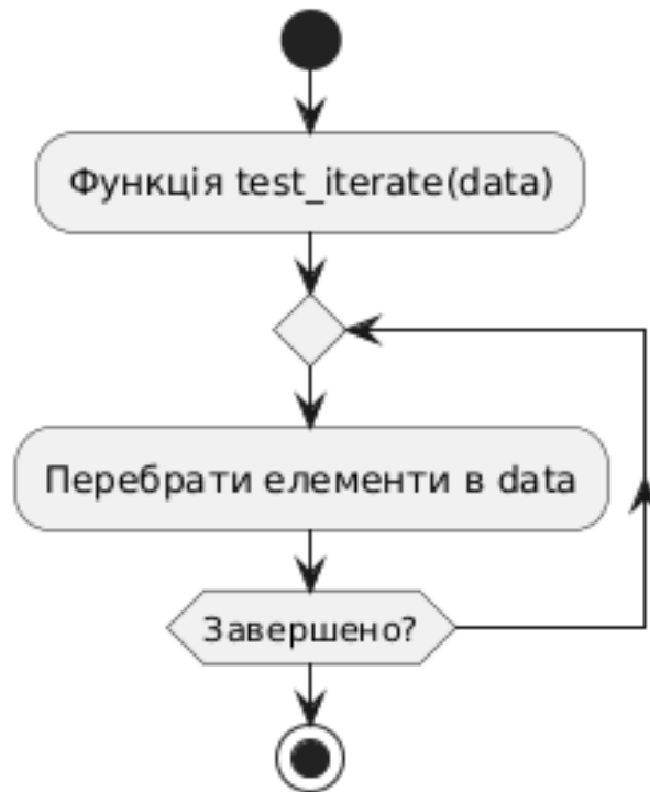
Рисунок 2.8 – Блок-схема тестування ітерації
