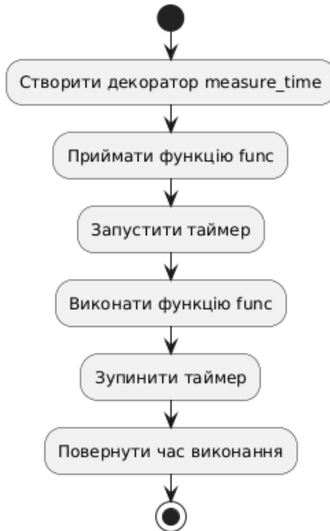
Рисунок 2.3 – Блок-схема декоратора вимірювання часу виконання
