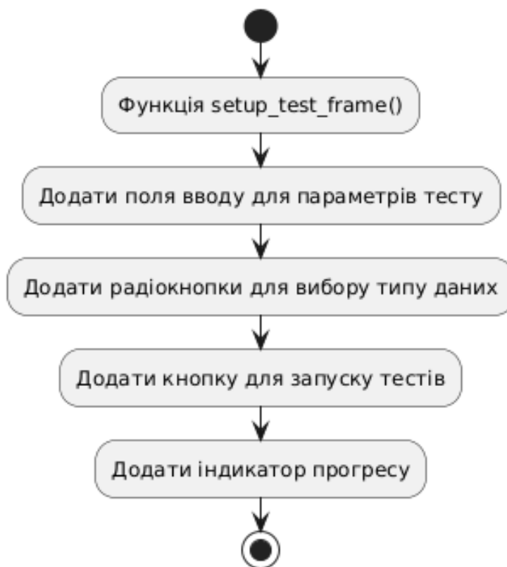
Рисунок 2.10 – Блок-схема налаштування вкладки тестування
