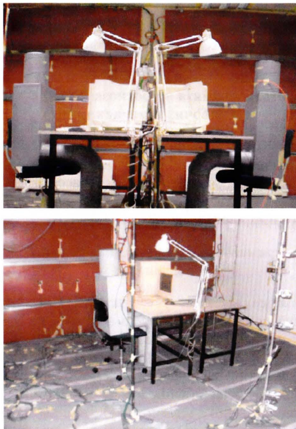
Рис. 1.14. Подготовка физического эксперимента по исследованию микроклимата в офисном помещении [154]
