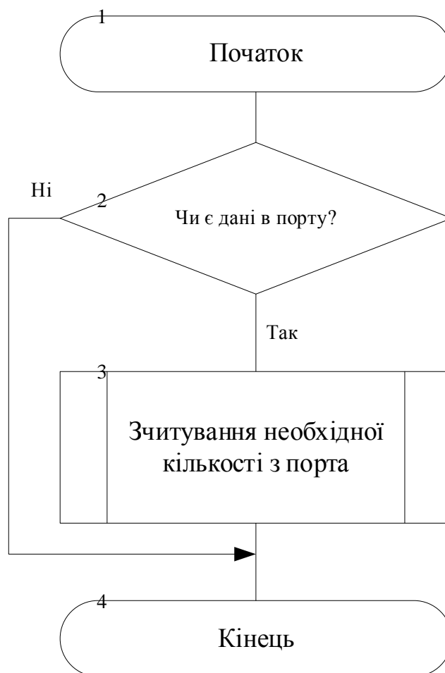
Рисунок 3.8 – Узагальнений алгоритм обробки події від послідовного порту
