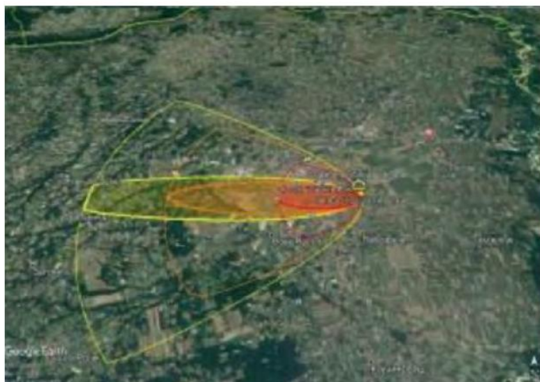
Рисунок 1.6 – Зона забруднення атмосферного повітря хлором при аварії на підприємстві, модель ALOHA [138]
