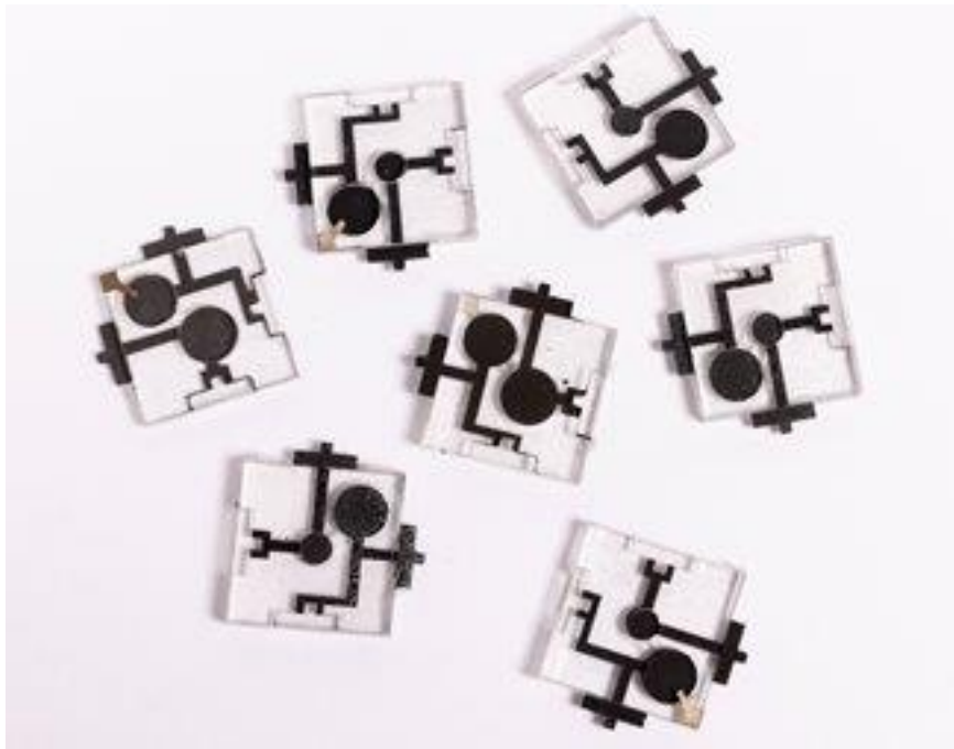
Рисунок 4.8 – Біобатарея професора Сокхвин Чхве
