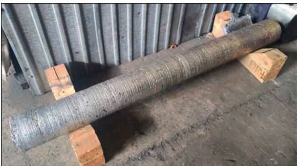
Рис. 4. Зливков діаметром 150 мм з нікелю електронно-променевого переплаву
