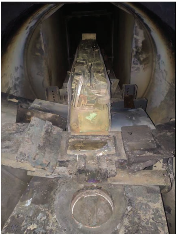
Рис. 2. Шихтова заготовка з низькосортного брухту нікелю
