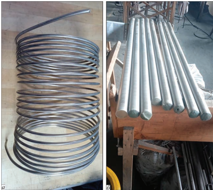
Рис. 5. Напівфабрикати з нікелю марки НП2, одержаного способом ЕПП: а — проволочка діаметром 3 мм; б — тягнуті м’які прутки діаметром 40 мм
