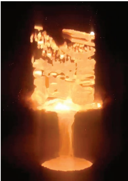
Рис. 3. Процес електронно-променевого переплаву нікелю
