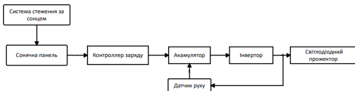
Рисунок 4 – Структурна схема системи автономного зовнішнього освітлення на фотоелектричних перетворювачах
