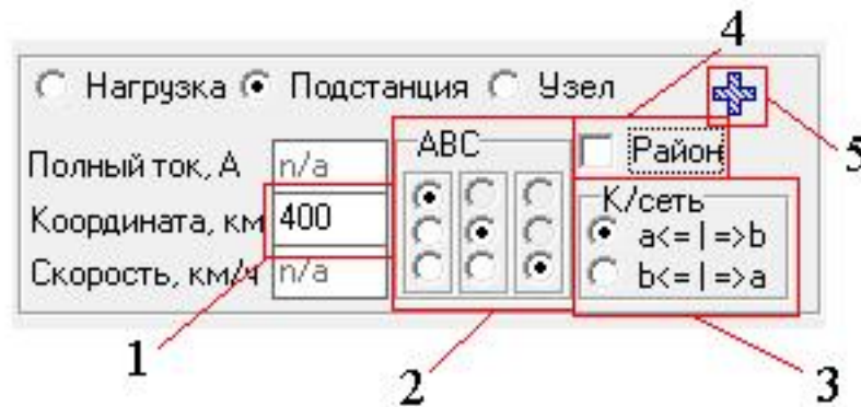
Рис. 7.8. Панель редагування схеми і навантажень головного вікна програми: 1- ввід координати розташування; 2 – вибір схеми підключення до первинної мережі; 3 - вибір схеми підключення до тягової мережі; 4 – вибір наявності районних споживачів; 5 – кнопка «Добавить»
