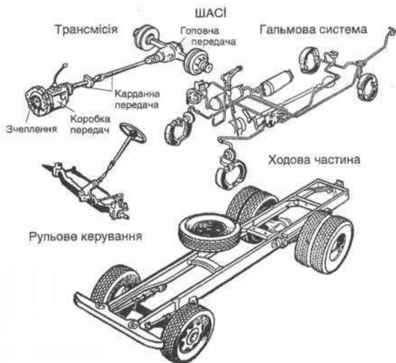
Рис. 1.1. Конструктивна база ходової частини, [1]
