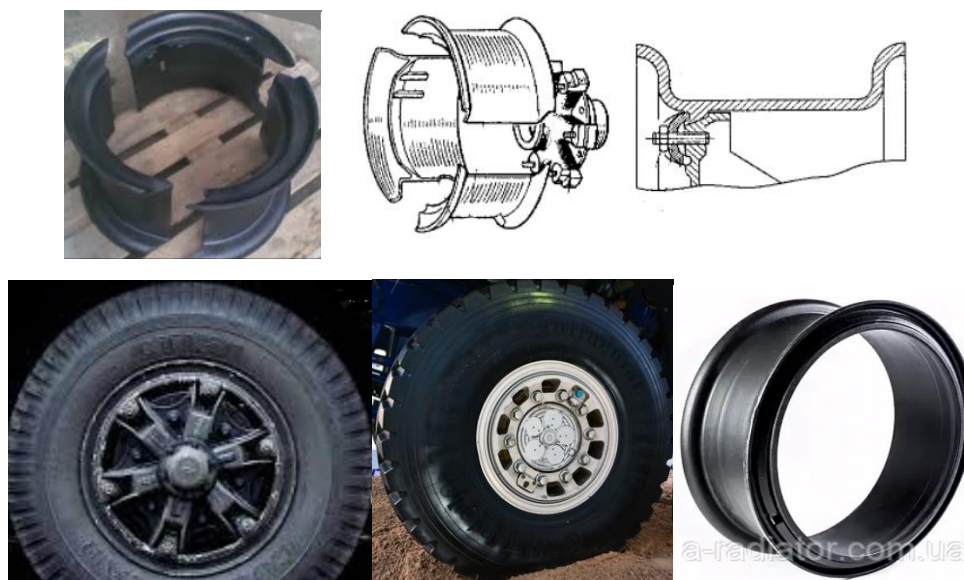
Рис. 1.20. Бездискове колесо і складальний обід колеса, [39]
