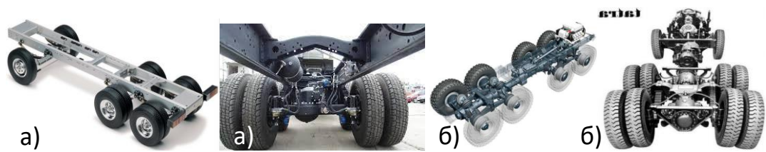
Рис. 1.16. Рами вантажівок лонжеронні (а) і хребтові (б), [37], [38]
