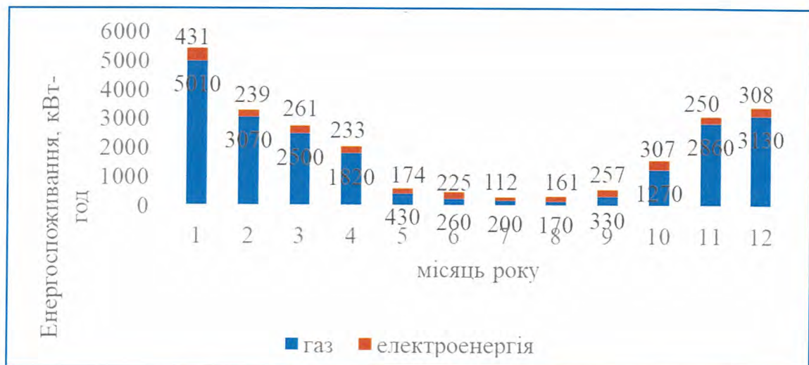
Рисунок 2.7 – Кінцеве споживання енергії домогосподарством: голубий – опалення, приготування гарячої води і їжі; помаранчевий – електроенергія на побутові потреби (2017 р.)
