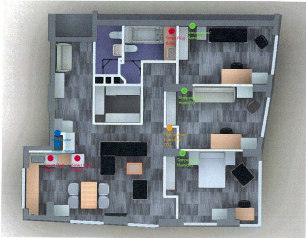
Рисунок 5.6 – Схема встановлення смартобладнання в типовій квартирі житлового комплексу
