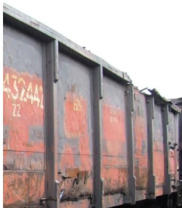
Рис.1. Пошкодження верхньої обв'язки бокової стіни напіввагона
