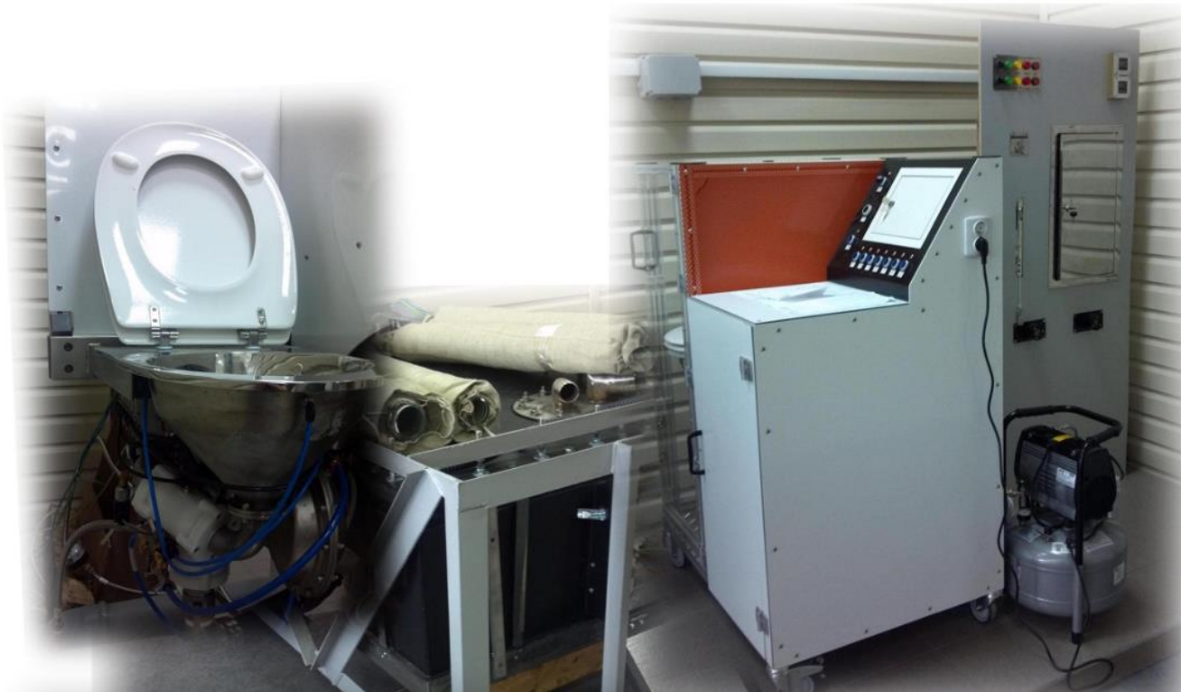
Рисунок 9 – Загальний вигляд стенду для проведення діагностики та ремонту вакуумних туалетів
